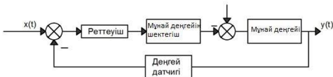
3.2 Сурет – Сепаратордың мұнай деңгейін автоматты реттеу жүйесінің құрылымдық сұлбасы
