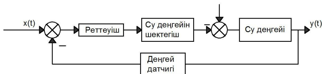
3.1 Сурет – Сепаратордың су деңгейін автоматты реттеу жүйесінің құрылымдық сұлбасы
